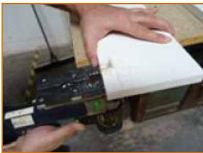
vyřezání vyznačených pozic na bočních dílech korpusu
