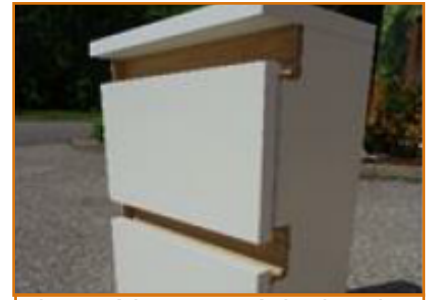
hotový korpus s úchytkami a s koncovými krytkami na jedné straně
