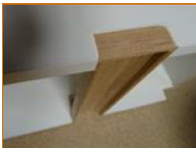
nalepení koncových krytek - vnější pohled
