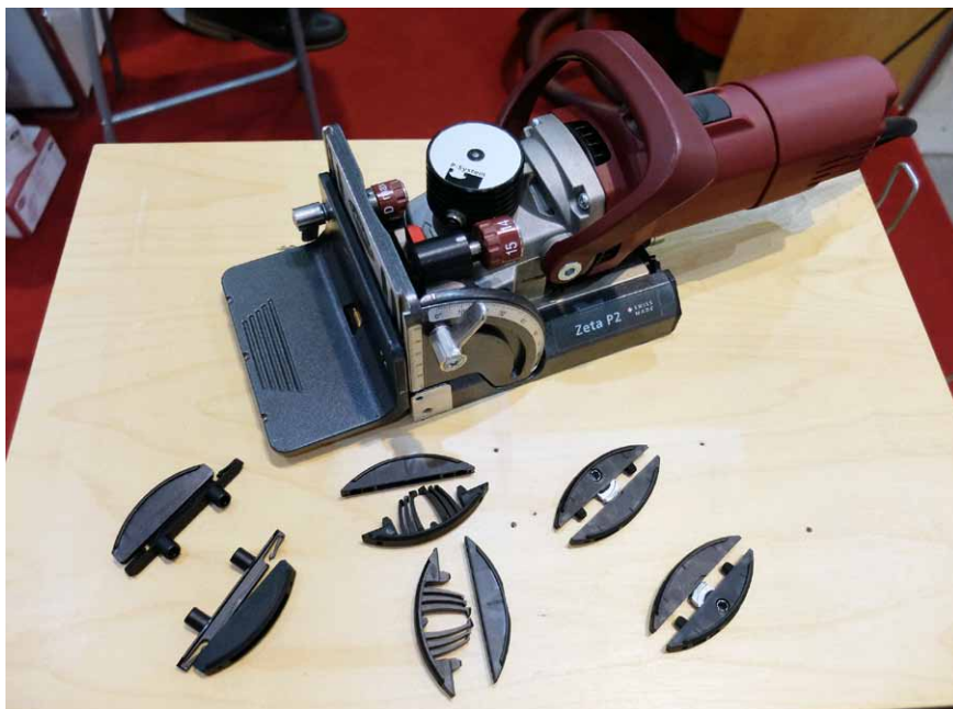
Ruční frézka Zeta P2 a spojovací prvky Clamex, Tenso a Divario tvoří základ spojovacího systému P-System
