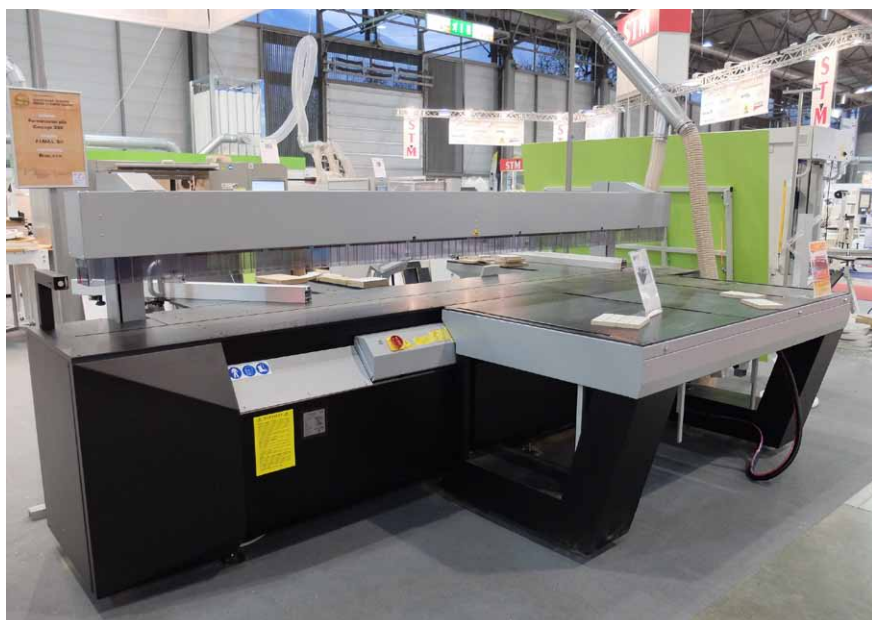
Formátovací pila Concept 350, určená hlavně malým firmám, tvoří mezistupeň mezi stolovou formátovací pilou a nářezovým centrem. Disponuje funkcí předřezu i naklápění pilového kotouče
