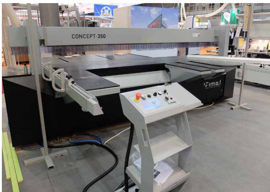
Formátovací pila Concept 350, určená hlavně malým firmám, tvoří mezistupeň mezi stolovou formátovací pilou a nářezovým centrem. Disponuje funkcí předřezu i naklápění pilového kotouče
